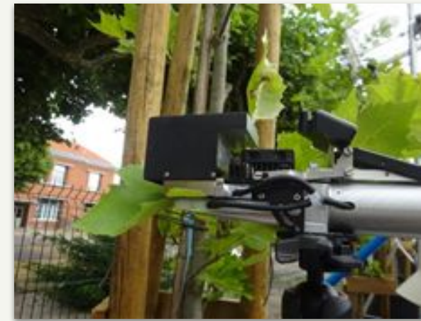
ANR sTREEt, mesure des échanges gazeux et de la fluorescence chlorophyllienne
