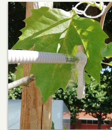
ANR sTREEt, mesure des échanges gazeux et de la fluorescence chlorophyllienne
