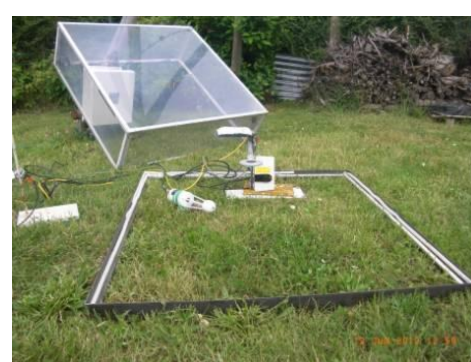
Figure 6 : Dispositif de mesure de l'évapo-transpiration par chambre mobile. Il mesure la radiation incidente ainsi que la température et l'humidité de l'air ventilé en interne. Ma mesure dure environ 2mn dont les 30 premières s sont exploitées.
