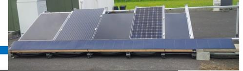
↳ Observer, mesurer, modéliser le comportement des modules PV de différentes technologies en conditions réelles de fonctionnement.
