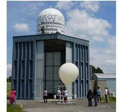
Figure 3 : préparation d'un attelage comparatif de 6 radiosondes à Payerne
