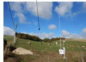
Ferme laitière (309 m) : station météo avec vent à 10m et capteur PWD (visibilité)
