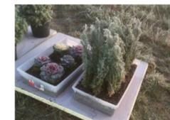
Pesées sur balances de précision à intervalle régulier (10 min) des bacs exposés au brouillard (Thèse de Jackie TAV)
