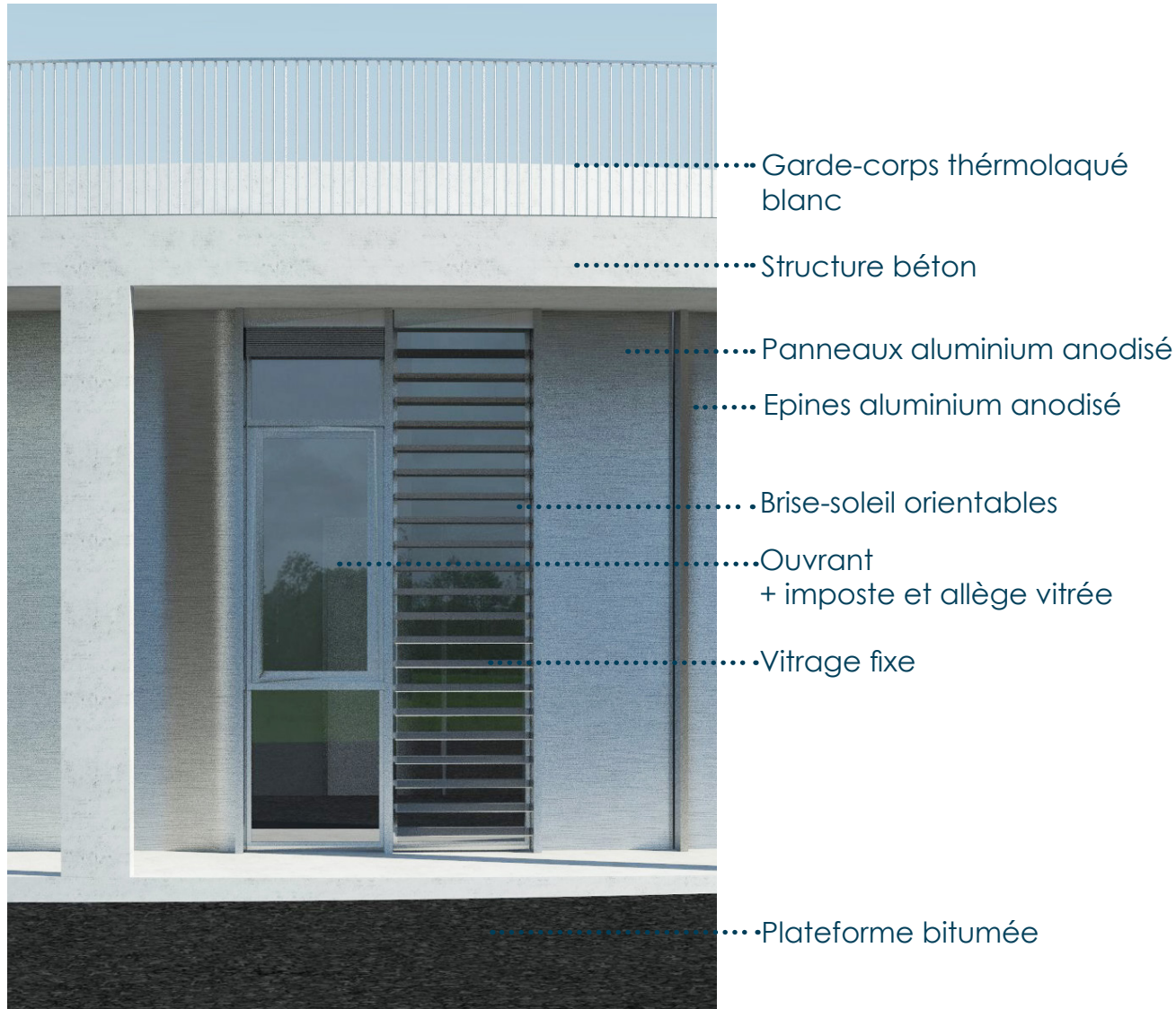
Détail de la façade de l'observatoire
