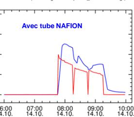
Pas d'impact de l'humidité sur les mesures grâce au tube Nafion
