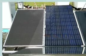
Fig.8- Illustration d'éclairage non-uniforme. Installation PV au SIRTA avec réflecteurs
