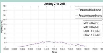
Fig.7- Comparaison entre la puissance mesurée et la puissance issue de la simulation, journée de 27 Janvier, installation sans réflecteurs
