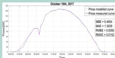
Fig.6- Comparaison entre la puissance mesurée et la puissance issue de la simulation, journée de 16 Octobre, installation sans réflecteurs
