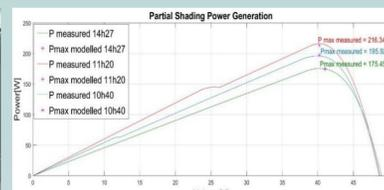
Fig.9- Caractéristiques courant-tension issues de la mesure et MPPT simulé pour une installation avec réflecteurs.
