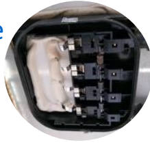
#16 diodes bypass défailtantes
