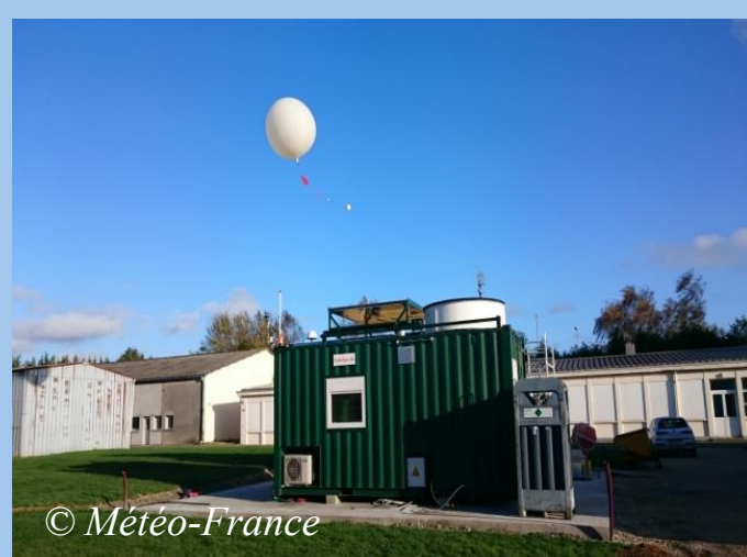
Robotsonde Meteomodem sur le site de Trappes à Météo France
