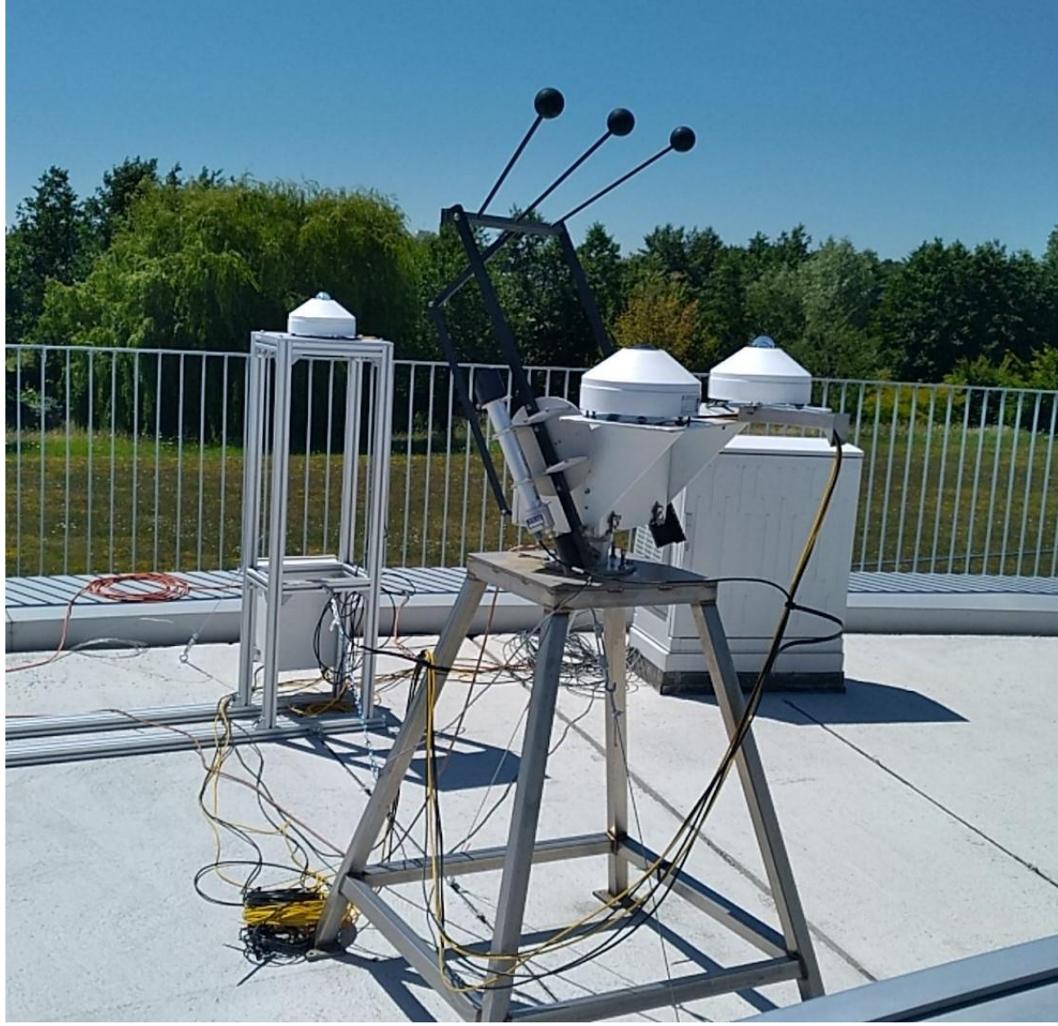
Système standard de mesure de BNI et DHI (radflux 1)
