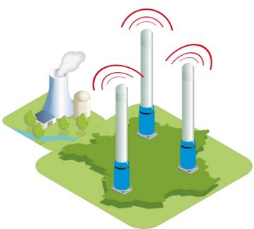
**SURVEILLANCE :** Le réseau TELERAY permet de connaître en temps réel l'état radiologique de l'environnement en France grâce aux mesures permanentes transmises, toutes les 10 minutes, au centre de supervision de l'IRSN.
