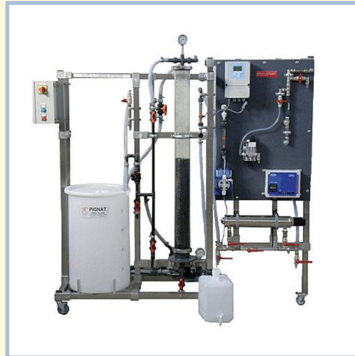
Pilote de filtration sur CAG
